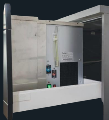
APERTURA LATO DX TERMOSTATI FREDDA E CALDA E LIVELLO BANCO DI GHIACCIO
